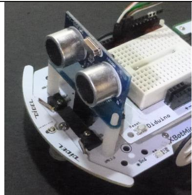
Le circuit SR05 a 5 broches: Gnd, Vcc (3.5V à 5.5V), Trig ( une impulsion de 10 us déclenche l'envoi d'un train d'impulsions à 40 kHz) et Echo (impulsion positive pendant le temps de vol, durée max en principe 200 ms s'il n'y a pas d'écho).
