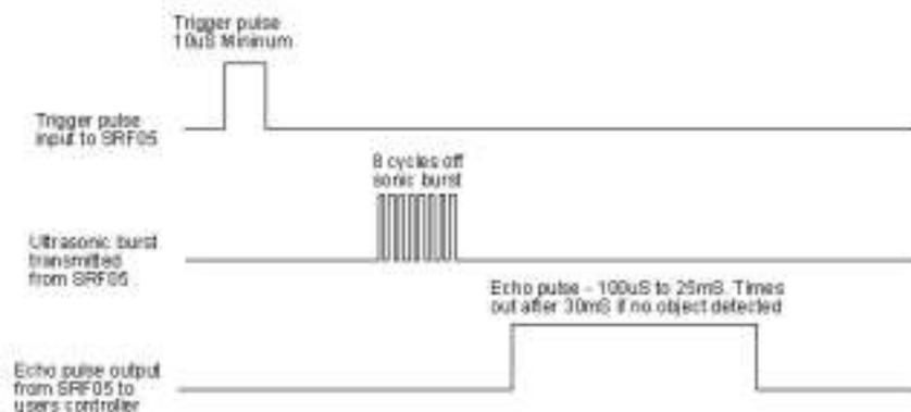
Attention, si la réflexion ne vient pas (trop loin ou paroi inclinée) la durée de Echo sur certains modèle dure 200 ms.
