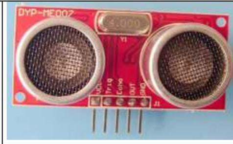
Une impulsion sur Trig déclenche l'envoi de 8 impulsions à 40 kHz et active le signal Echo, qui est désactivé quand l'écho revient (min 2cm 100 us). La durée d'un aller retour pour une distance de 25cm est environ 1,3 ms. Si la distance est trop grande, le signal reste à 1 (et le signal out est parfois activé).
