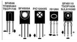
On utilise l'infrarouge, à la longueur d'onde de 940 nm en général, pour être moins sensible à la lumière du jour. Dans un éclairage artificiel les néons et leds blanches émettent peu d'infrarouge, mais un éclairage avec des ampoules à filament génère beaucoup d'infrarouge.
