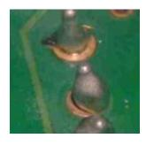
Insérer le processeur. Ne pas forcer et risquer de tordre une patte. Secouer en pressant un peu et presser à fond quand toutes les pattes sont alignées dans leurs trous.
