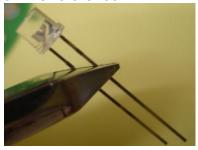
La pile disque CR1632 vous permet de vérifier les couleurs, mais **attention**, **ne pas utiliser une autre pile**! La CR1632 a une résistance interne qui limite le courant. Avec une pile de plus de 3V, ou un transfo donnant une tension quelconque, même alternative, il faut mettre une résistance en série de 1 kOhm au moins.
