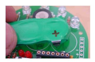
Si on voit la pastille cuivrée, la soudure est sûrement mauvaise. Rechauffer!
