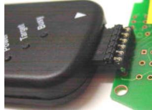
Un connecteur femelle 0.7mm (fourni avec les PicKit2 de BricoShop) est soudé sur le circuit du Bimo.
