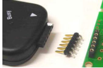
La solution conseillée est d'utiliser un connecteur intermédiaire male coudé, qui reste attaché au PicKit2.
